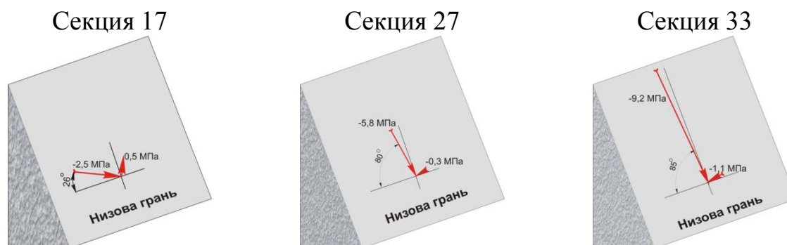
Рис.5. Величины и направления действия главных напряжений на низовой грани плотины (отм.312 м)
