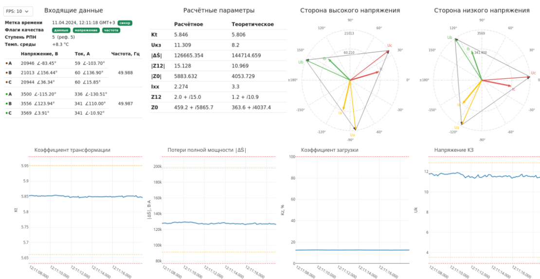
Рис 6. Веб-интерфейс системы мониторинга трансформатора.
