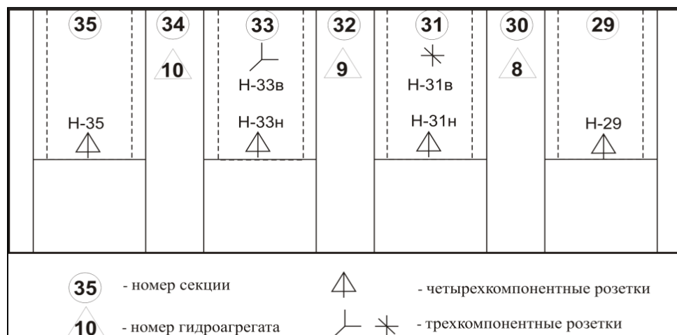
Рис.6. Замерные станции в секциях 29–35 низовой грани на отм. 310–312 м
